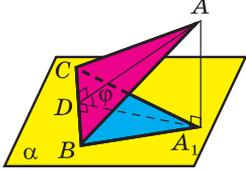
$S_{\text{проекции}} = S_{\text{фигуры}} \cdot \cos \varphi,$ <p>где <math>\varphi</math> — угол между плоскостью фигуры и плоскостью проекции</p> |
