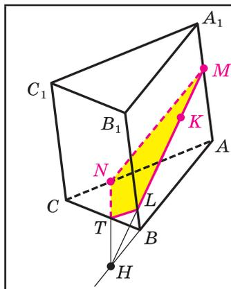
3. Тогда точка  $H$  лежит и в плоскости сечения, и в плоскости  $ABC$ . По условию точка  $N$  также лежит и в плоскости сечения, и в плоскости  $ABC$ . Следовательно, плоскость сечения пересекает плоскость основания по прямой  $HN$  (след секущей плоскости на плоскости  $ABC$ ), пересекающейся с прямой  $BC$  в точке  $T$ .
